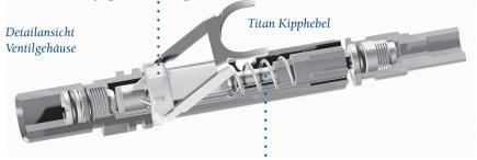
**Balancierter Kolben:** Aerodynamischer, balancierter Kolben gewährleistet gesteigerte Luftlieferung und leichteres Einatmen unabhängig vom Flaschendruck. Siehe nachfolgende Abbildung Position -2.
